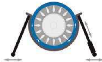
Sistema hidráulico de levantamiento de cubeta
