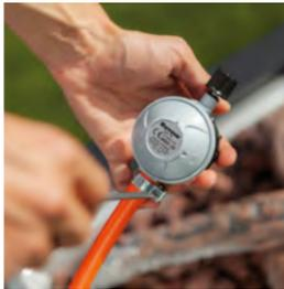
Conectamos el extremo de la manguera al regulador del gas con la ayuda de las abrazaderas.
