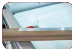
Barra de soldadura extraíble para facilitar limpieza.
