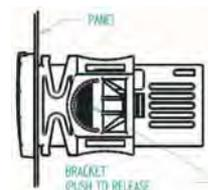
Los instrumentos deben ser montados en panel, en una perforación de 29x71 mm, y fijados usando las fijaciones que se acompañan. La temperatura ambiente en torno al instrumento debe estar en el rango 0÷60 °C para una correcta operación del aparato. Evite lugares sujetos a fuertes vibraciones, gases corrosivos, suciedad excesiva o humedad. Las mismas recomendaciones se aplican a las sondas. Déjese circular aire a través de las rendijas de enfriamiento.
