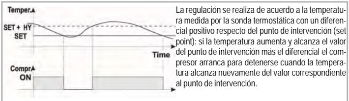
En caso de fallo en la sonda termostática el arranque y detención del compresor se calcula conforme lo programado en los parámetros 'Cy' y 'Cn'.
