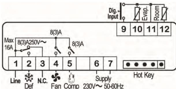
Alimentación: modelos 120Vac. Utilizar terminales de alimentación 6 y 7.
