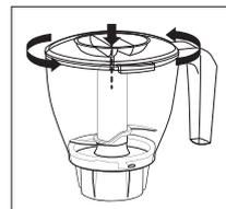
5. Coloque el accesorio picadora ensamblado en la base del motor.
