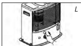
2 Oprima el botón del encendido 3 (fig. L) sin ejercer fuerza. En cuanto se aprecie una llama en la cámara de combustión 4, suelte el botón.
