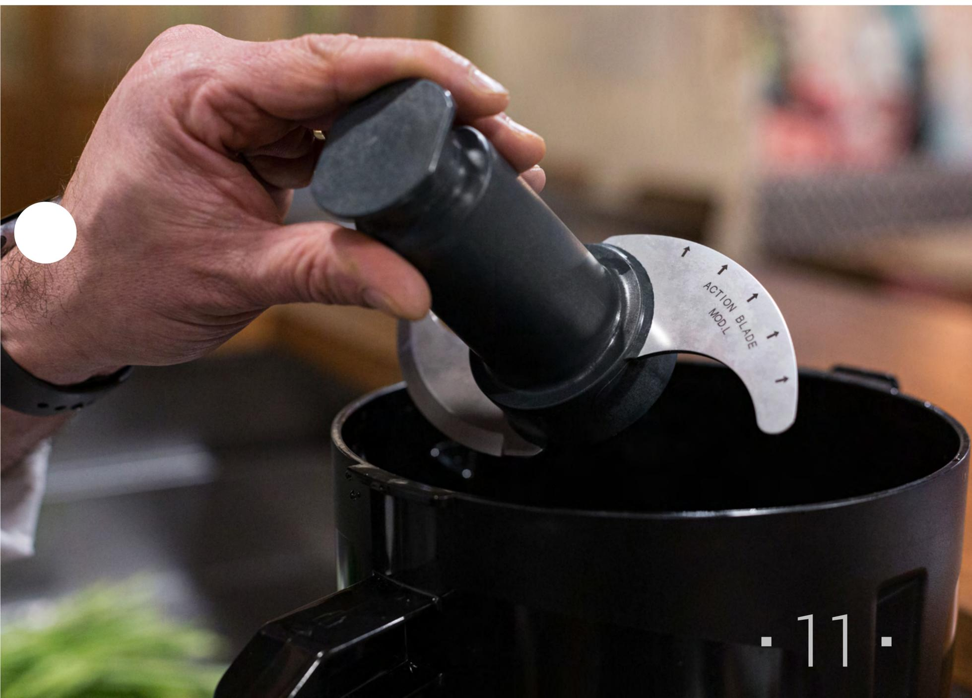
La cuchilla superior del rotor tiene el filo invertido, haciendo que el producto se mueva hacia abajo. En cambio, la cuchilla inferior con el filo normal hace que el producto se mueva hacia arriba. Así, gracias al movimiento que crean los diferentes filos, se obtienen acabados mucho más uniformes.
